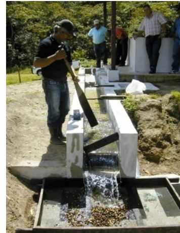
Unité de transformation du café par voie humide respectueuse de l'environnement, préconisée par les projets FCPB/OIC en Amérique centrale
